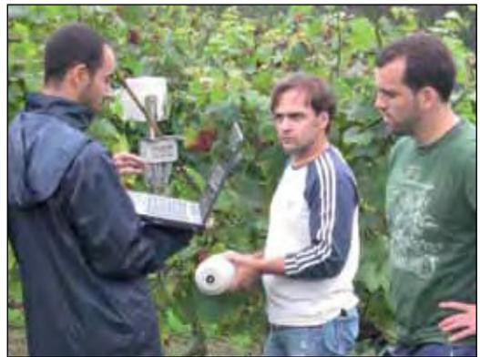
LÁMINA IV. Instalación y descarga de datos de las estaciones agroclimáticas.
